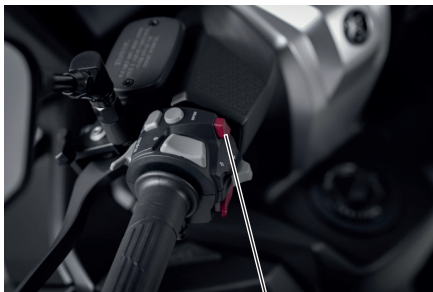
Segnalazione di emergenza (Hazard)
